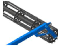
**Комбинированные катки предназначены для средней и тяжелой почвы.** Обеспечивают создание микрорельефа почвы для посева, оптимальное крошение почвы, дробление комков и вычесывание подрезанной сорной растительности.
