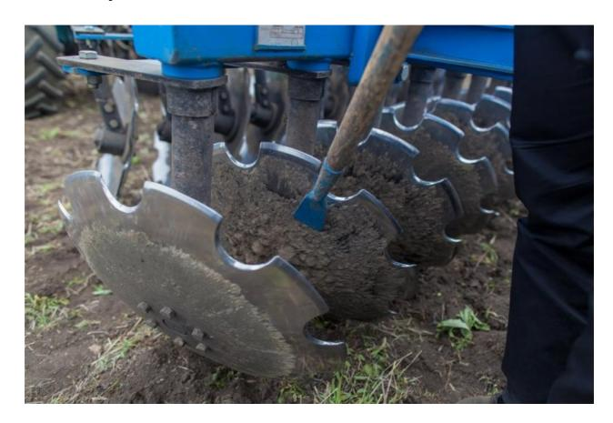
Прицепная двухрядная дисковая борона DANA БДП-3,2×2 предназначена для ресурсосберегающей предпосевной и основной обработки почвы на глубину от 8 до 15 см под зерновые, технические и кормовые культуры, уничтожения сорняков и измельчения пожнивных остатков после уборки посевных культур, омоложения лугов и пастбищ, а также измельчения, выравнивания и уплотнения почвы.
