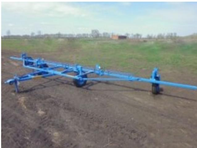
Сцепка предназначена для составления тракторных гидрофицированных и негидрофицированных широкозахватных агрегатов для предпосевной обработки почвы, ухода за парами, посева зерновых, зернобобовых культур и других сельскохозяйственных работ.
