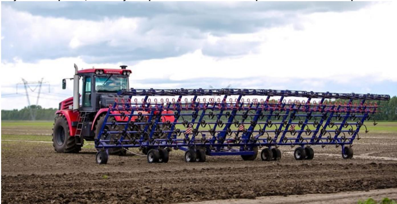
"АЛТАЙ" КСУ-11 предназначен для ранней предпосевной подготовки почвы, выравнивания поверхности поля, уничтожения сорной растительности, обработки пара, для равномерного распределения и заделки в почву удобрений и мелких пожнивных остатков, а также осенней обработки зяби на глубину до 12 см.
