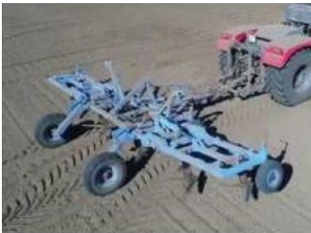
**Культиватор-плоскорез широкозахватный КПШ-9** предназначен для паровой и осенней обработки почвы, а также предпосевной обработки почв, лёгких по механическому составу, с максимальным сохранением стерни и других пожнивных остатков на поверхности поля после колосовых и пропашных предшественников. Сохранение стерни защищает почву от ветровой эрозии, что актуально для степных районов и районов с недостаточным увлажнением.
