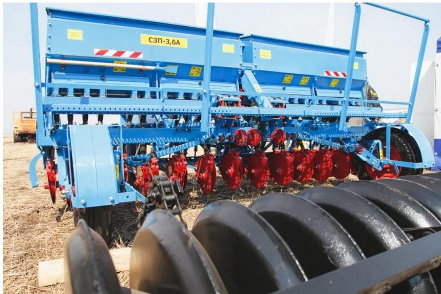
**Сеялка зернотуковая прессовая VITA СЗП-3,6А** предназначена для рядового посева семян зерновых культур, бобовых культур с одновременным внесением в засеваемые рядки гранулированных минеральных удобрений. Зернотуковая прессовая сеялка VITA СЗП-3,6А — это современная сельскохозяйственная машина с высокими эксплуатационными возможностями, надежная и недорогая.
